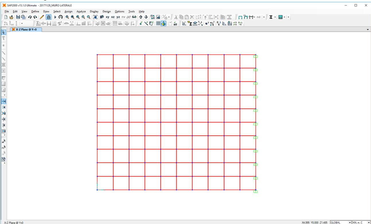
Il muro laterale è stato modellato mediante elementi bidimensionali tipo “shell” con comportamento a lastra – piastra. Il muro è stato vincolato verticalmente su un singolo lato mediante vincoli di incastro.
