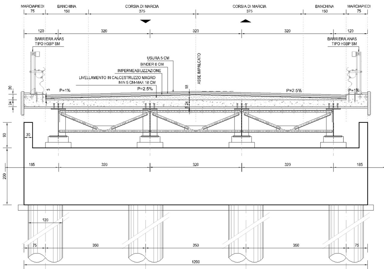
FIGURA 1 - SEZIONE TIPICA IMPALCATO (SU SPALLA)
