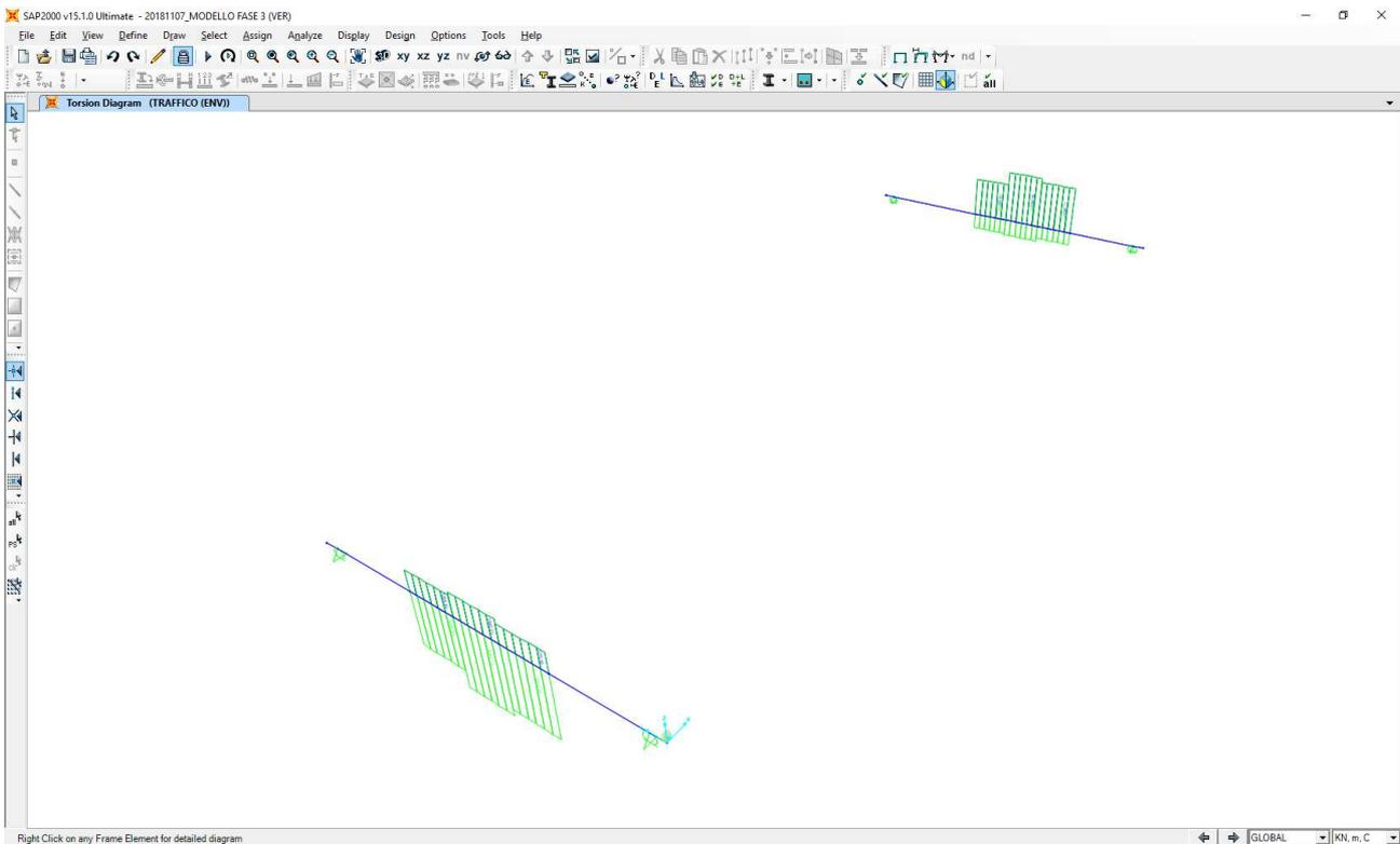
Nell'immagine successiva è riportato l'andamento dell'azione tagliante longitudinale caratteristica per la combinazione di involuppo delle differenti condizioni di traffico veicolare considerate:
