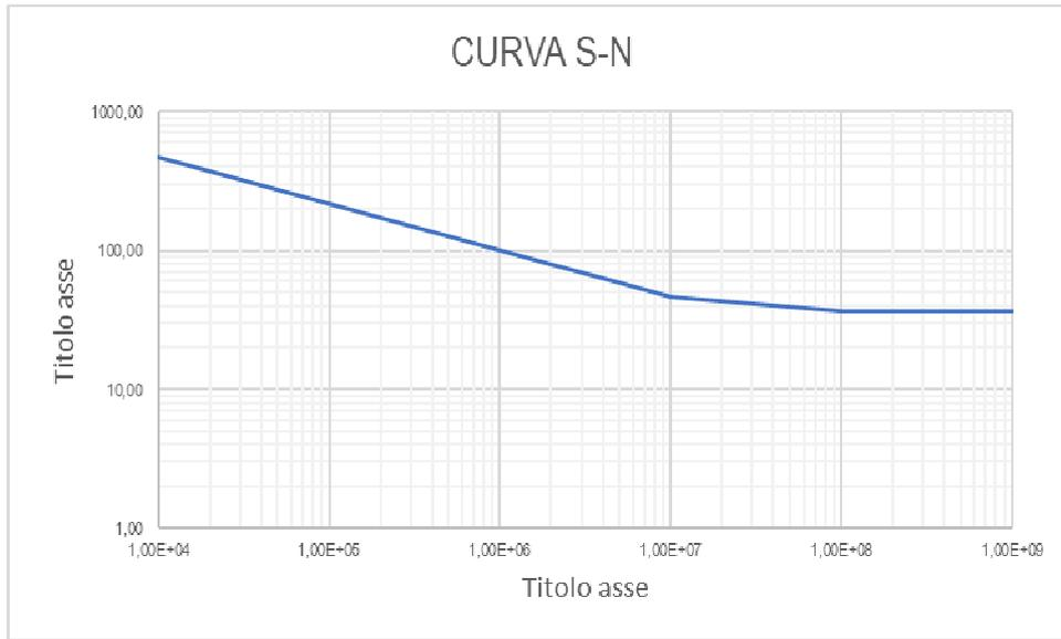
Il valore del limite di fatica ad ampiezza costante utilizzato nelle verifiche delle piattabande è assunto pari a:
