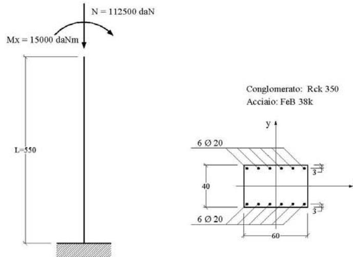
L'esempio, tratto dal volume di R.Calzona, C.Cestelli Guidi – Il calcolo del cemento armato (Hoepli) – si riferisce al calcolo allo stato limite ultimo di instabilità di un pilastro snello a sezione rettangolare i cui dati sono riportati in figura.
