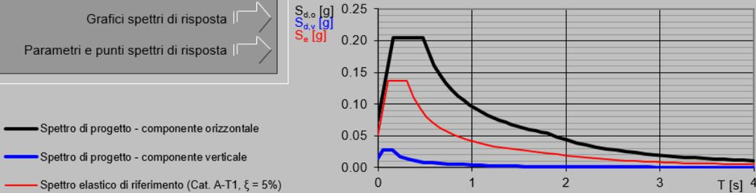
**Parametri e punti dello spettro di risposta orizzontale per lo stato limiSLV**
