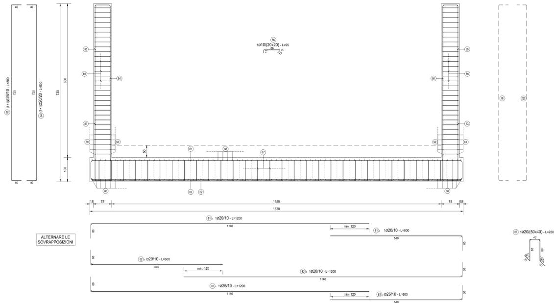
**DETTAGLIO RINGROSSO - SEZIONE LONGITUDINALE**
