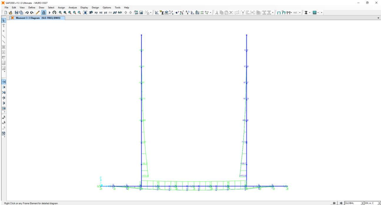
Nell'immagine successiva è riportato l'andamento del taglio per la combinazione di involuppo delle combinazioni di carico statiche allo Stato Limite di Esercizio – Frequenti:
