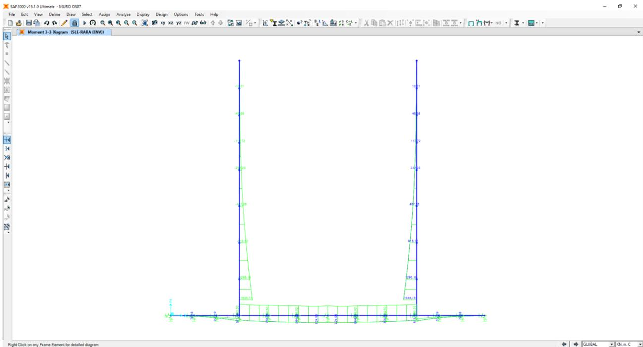
Nell'immagine successiva è riportato l'andamento del taglio per la combinazione di involucro delle combinazioni di carico statiche allo Stato Limite di Esercizio – Rare:
