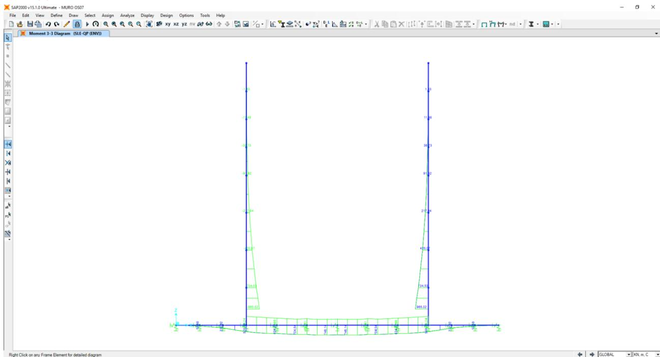
Nell'immagine successiva è riportato l'andamento del taglio per la combinazione di involuppo delle combinazioni di carico statiche allo Stato Limite di Esercizio – Quasi Permanenti:
