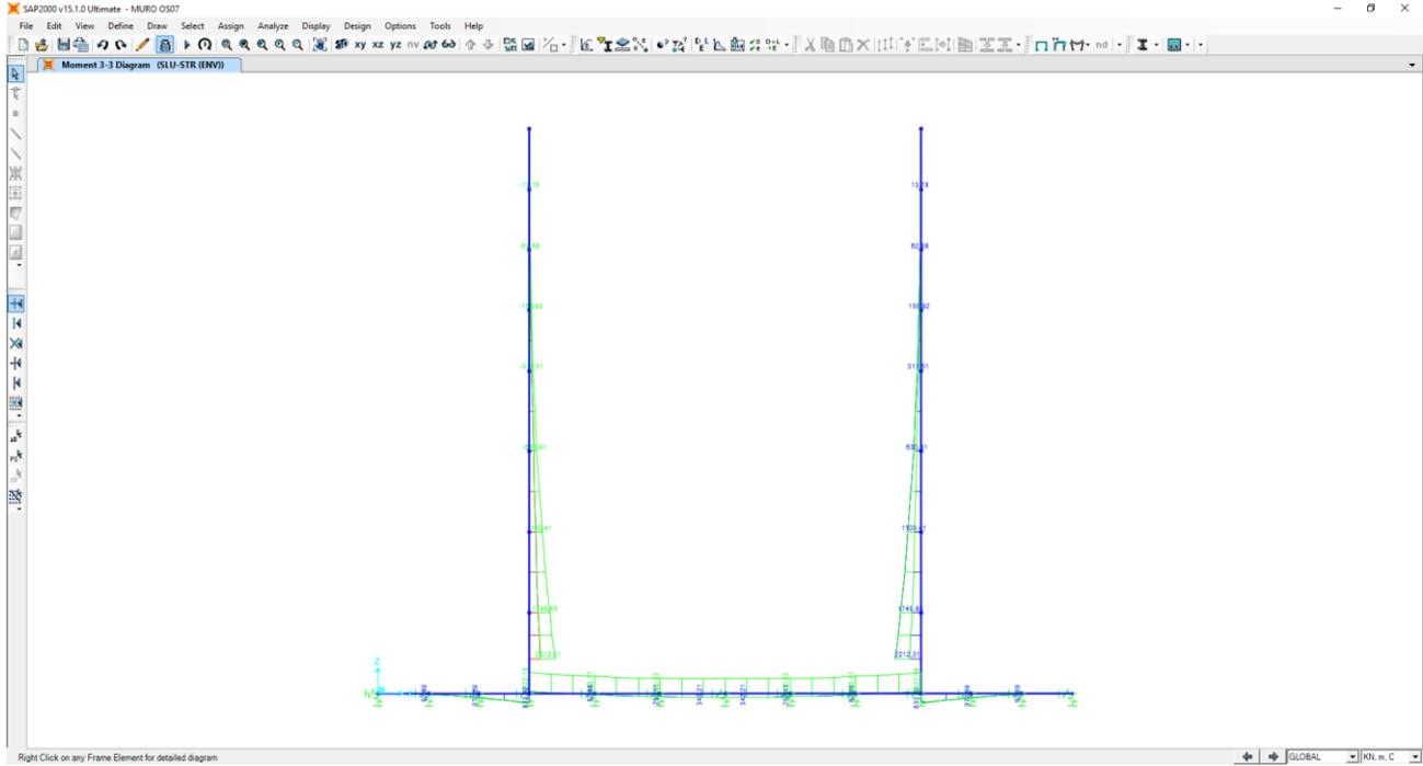
Nell'immagine successiva è riportato l'andamento del taglio per la combinazione di involuppo delle combinazioni di carico statiche allo Stato Limite Ultimo - STR:
