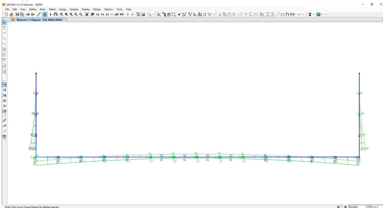
Nell'immagine successiva è riportato l'andamento del taglio per la combinazione di involuppo delle combinazioni di carico statiche allo Stato Limite di Esercizio – Rare:
