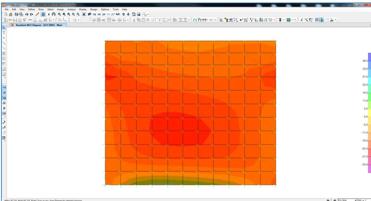
Nell'immagine successiva è riportato l'andamento dell'azione tagliante longitudinale di calcolo V13:
