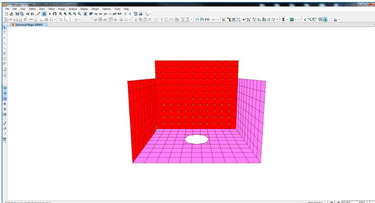
Gli elementi strutturali sono stati modellati mediante elementi bidimensionali tipo “shell”, con comportamento a “lastra – piastra” e con spessore pari allo spessore reale della sezione strutturale.
