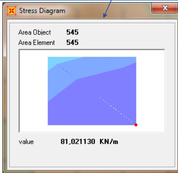
L'azione tagliante di calcolo è assunta pari a  $V_{S,d} = 81,02$  kN.
