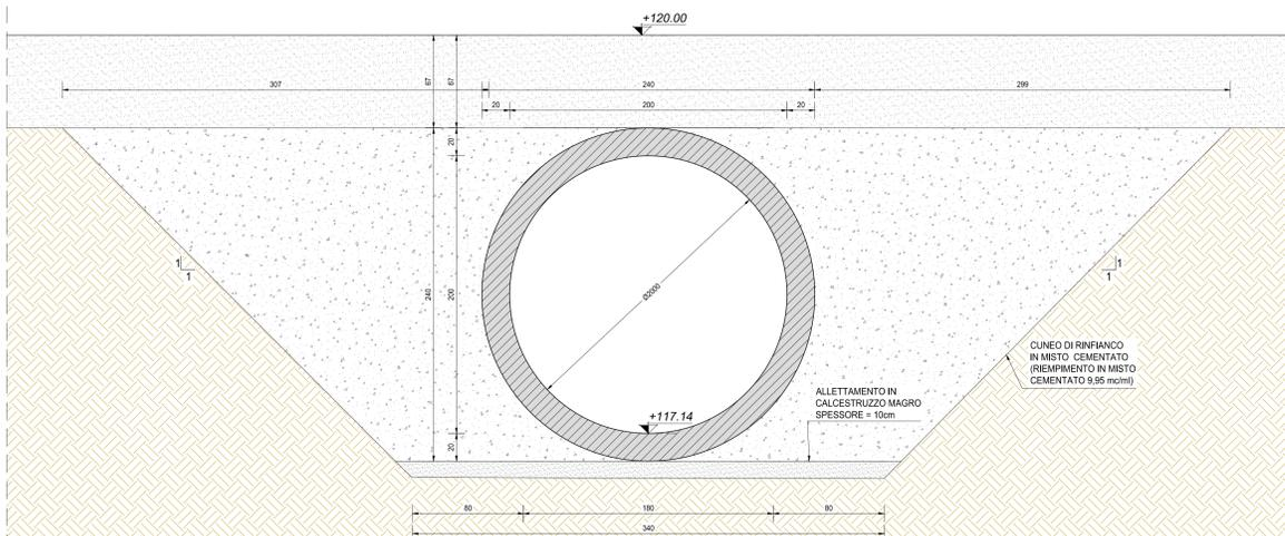
SEZIONE TRASVERSALE IN ASSE STRADA (SEZIONE D-D)
