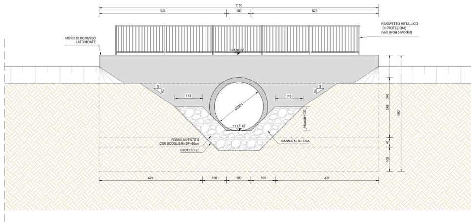
VISTA PROSPETTICA MURO DI SBOCO (SEZIONE E-E)
