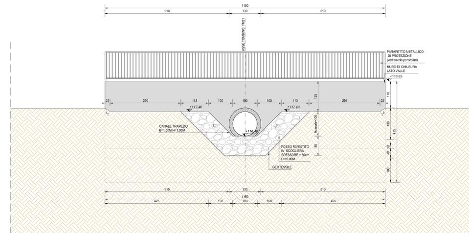
SEZIONE TRASVERSALE IN ASSE STRADA (SEZIONE D-D)
