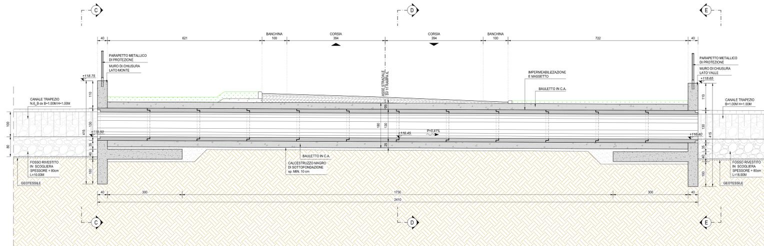
VISTA PROSPETTICA MURO DI SBOCO (SEZIONE C-C)
