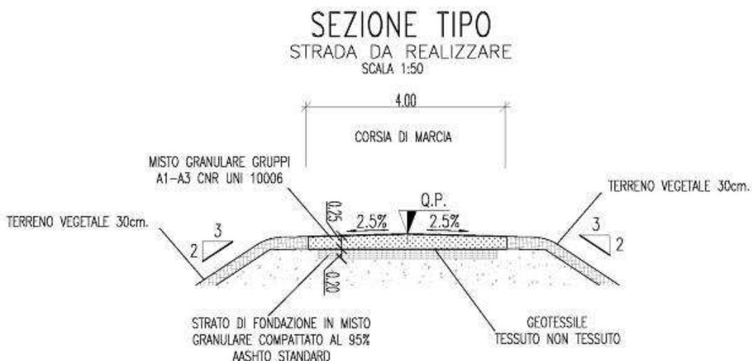
Figura 3.18: Sezione tipo trasversale del tratto di strada da realizzare.
