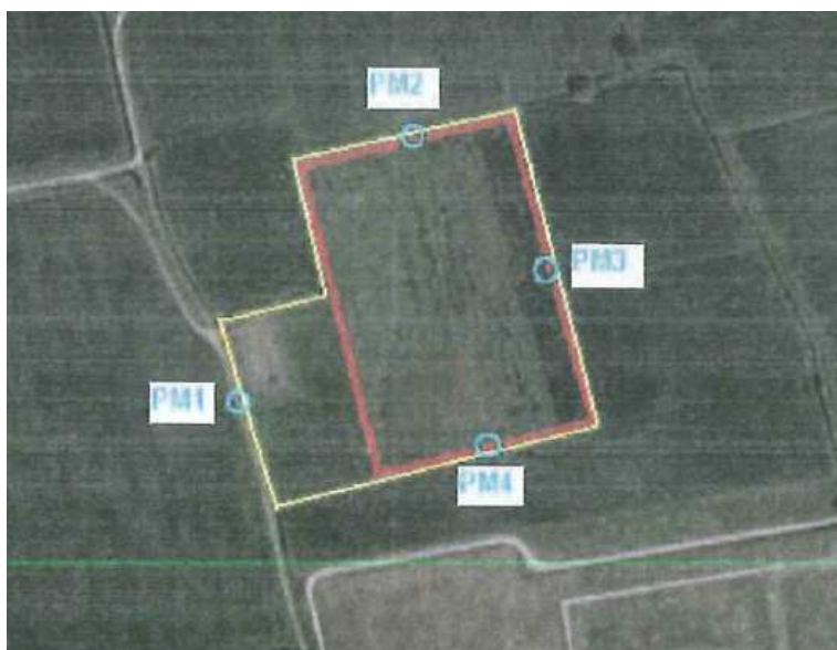
Figura 6.2: Ubicazione dei punti di misura del rumore effettuati presso cantiere di perforazione analogo a quello in oggetto.
