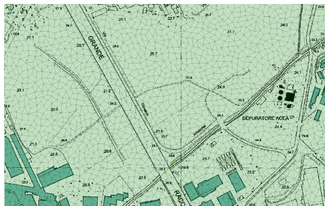
Figura 24. Particolare della Mesh di calcolo triangolare con elementi aventi area compresa tra 150 e 200 m<sup>2</sup> in verde scuro i poligoni rappresentanti gli edifici
