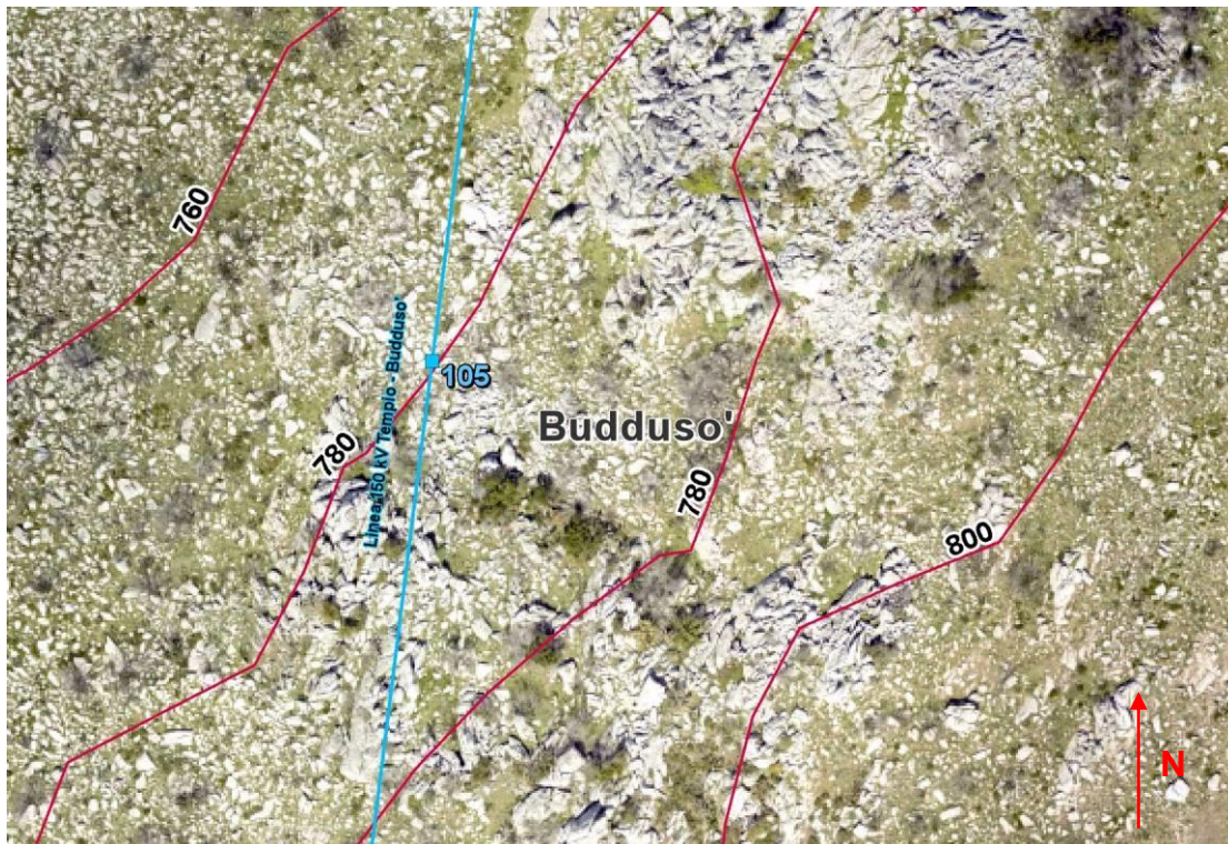
Ortofoto aerea di dettaglio relativa al sostegno n. 105 In rosso sono indicate le isoipse con le relative quote altimetriche espresse in metri.
