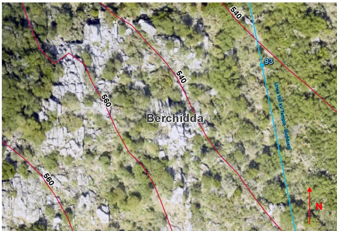
Ortofoto aerea di dettaglio relativa al sostegno n. 93 In rosso sono indicate le isoipse con le relative quote altimetriche espresse in metri.
