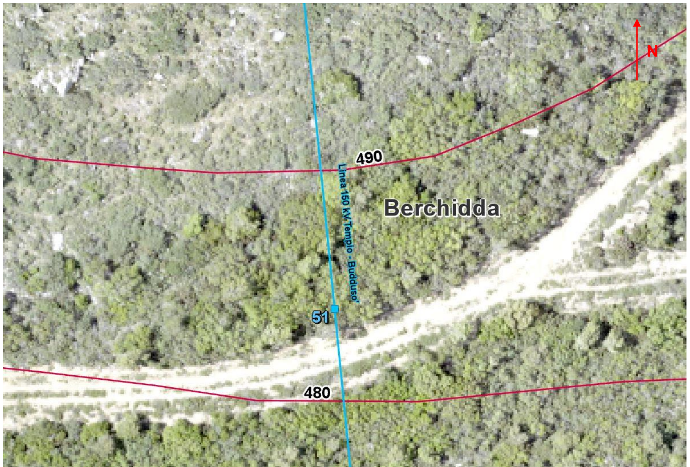
Ortofoto aerea di dettaglio relativa al sostegno n. 51. In rosso sono indicate le isoipse con le relative quote altimetriche espresse in metri.
