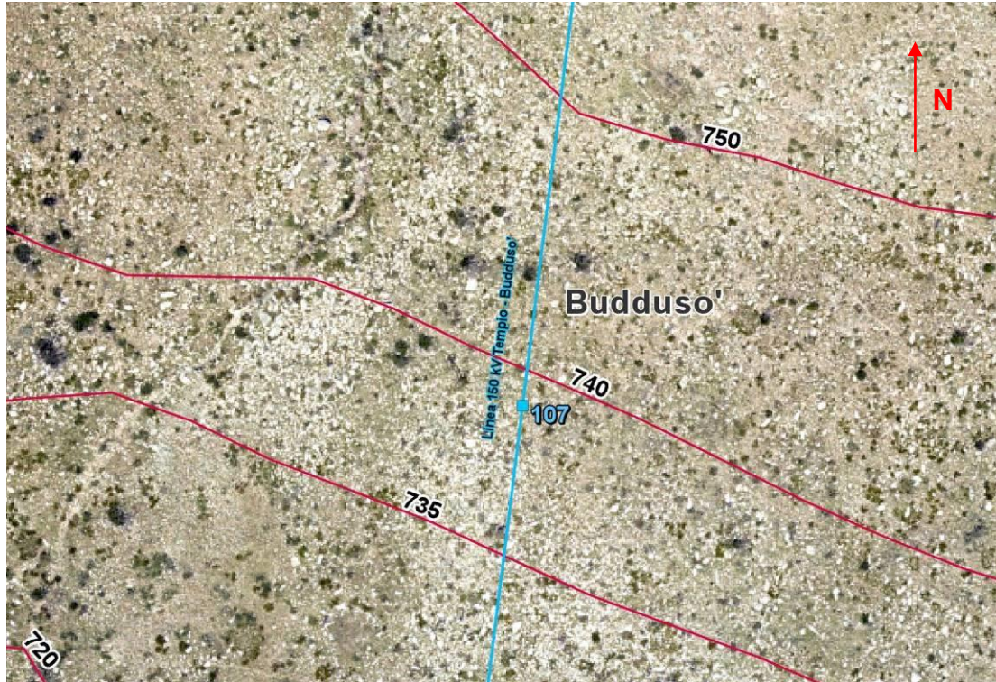
Ortofoto aerea di dettaglio relativa al sostegno n. 107. In rosso sono indicate le isoipse con le relative quote altimetriche espresse in metri.
