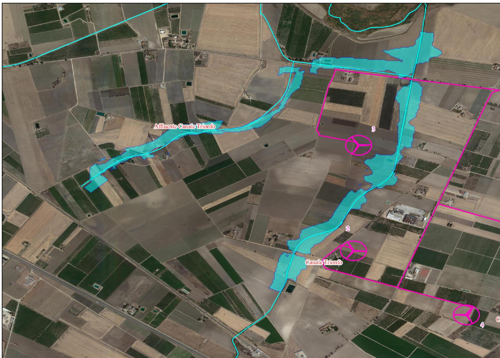
Figura 5. Planimetria con individuazione delle sezioni e delle aree potenzialmente interessate dalla portata avente tr = 200 anni
