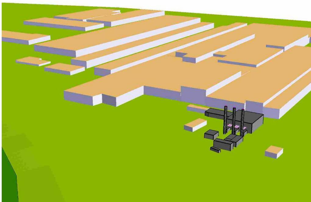
Il calcolo dei livelli di pressione sonora generati dalla centrale di cogenerazione nell'assetto complessivo di progetto è stato condotto su una mesh di calcolo di maglia 10 metri che comprende l'intero stabilimento Marcegaglia e l'area ad esso adiacente, ad una quota di 1.5 metri di altezza dal terreno.
