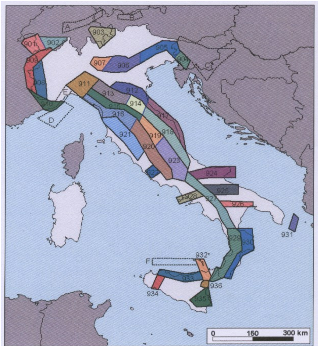
Fig. 1 – Zonazione sismogenetica ZS9. I limiti di colore blu separano zone con analogo significato cinematico, che differiscono principalmente per le caratteristiche di sismicità. Le ZS con bordo a tratteggio, identificate con una lettera, non sono utilizzate nella valutazione della pericolosità.
