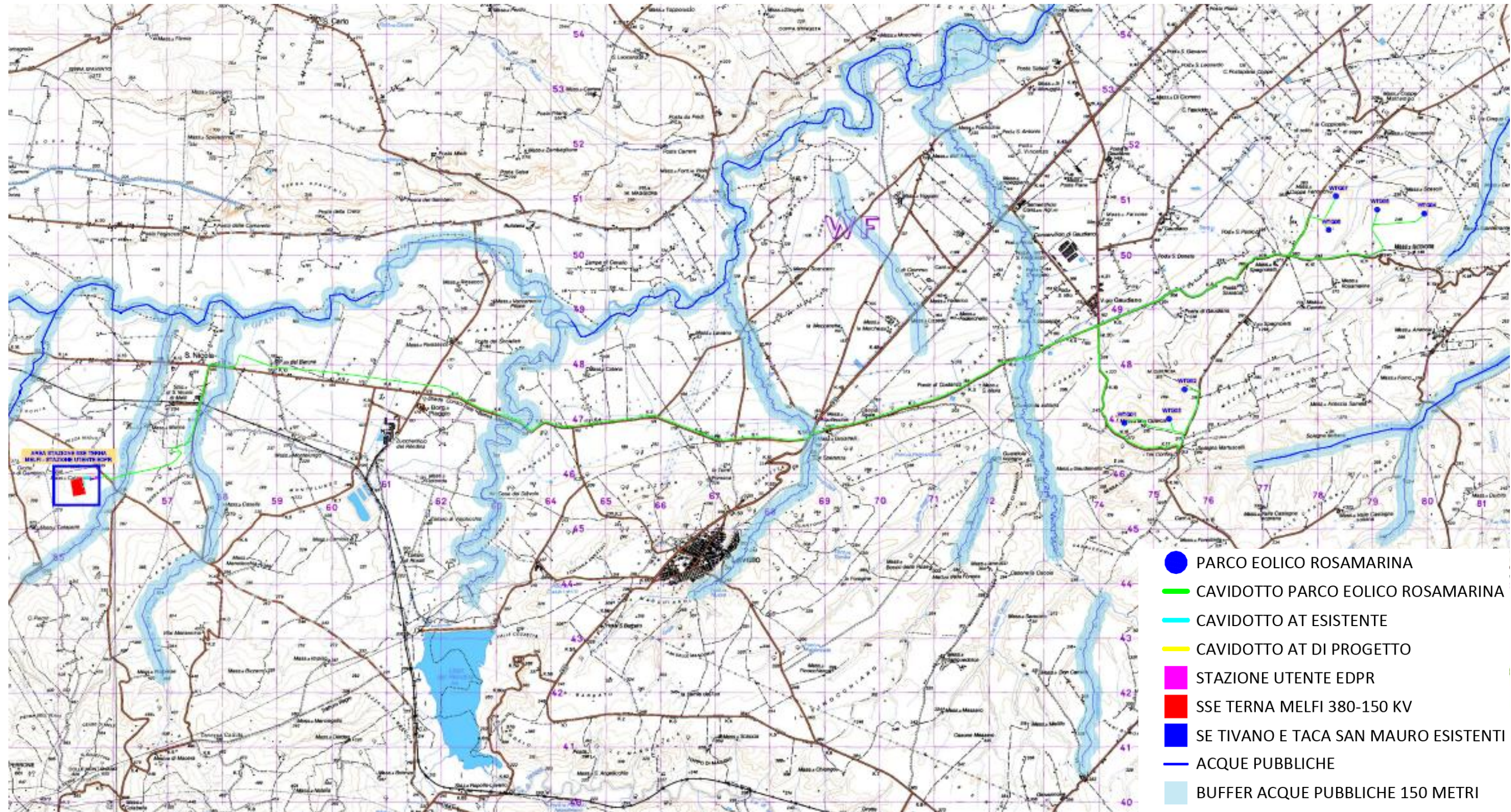
Figura 62 – Compatibilità del parco eolico di progetto rispetto al PEAR: distanza dalle acque pubbliche
