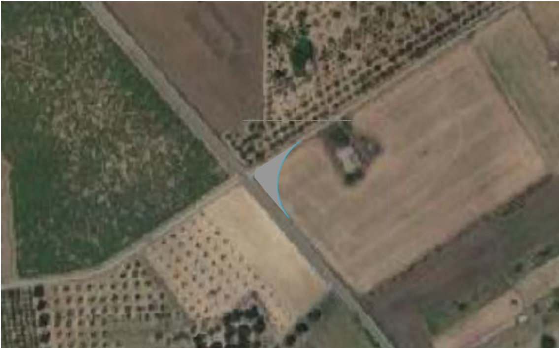
Intervento 9: Consiste in un allargamento della carreggiata per consentire manovra di immissione su strada comunale di avvicinamento alla torre M04.
