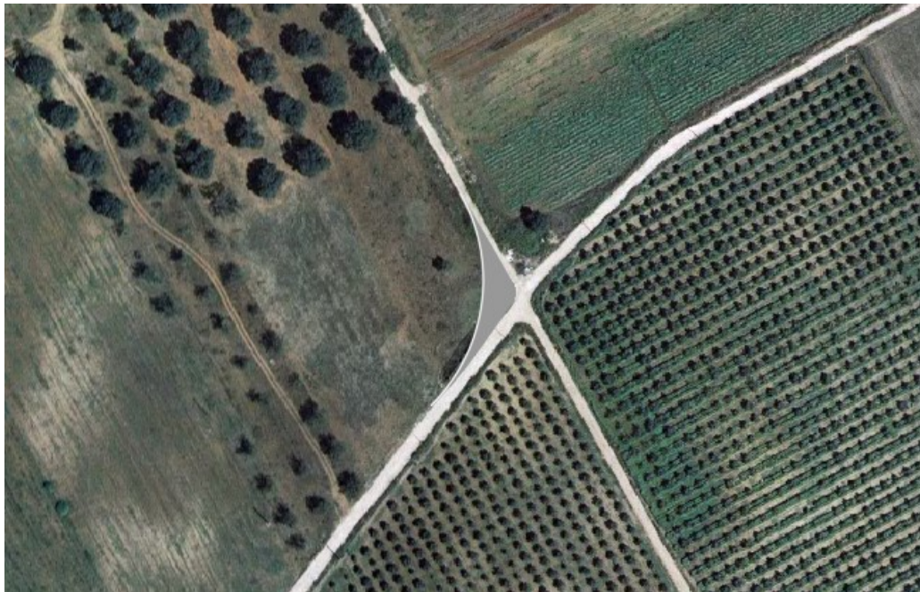
Intervento 2: Allargamento del ciglio destro della intersezione per la manovra a destra da Strada Comunale n. 50 a Strada Comunale n. 16.
