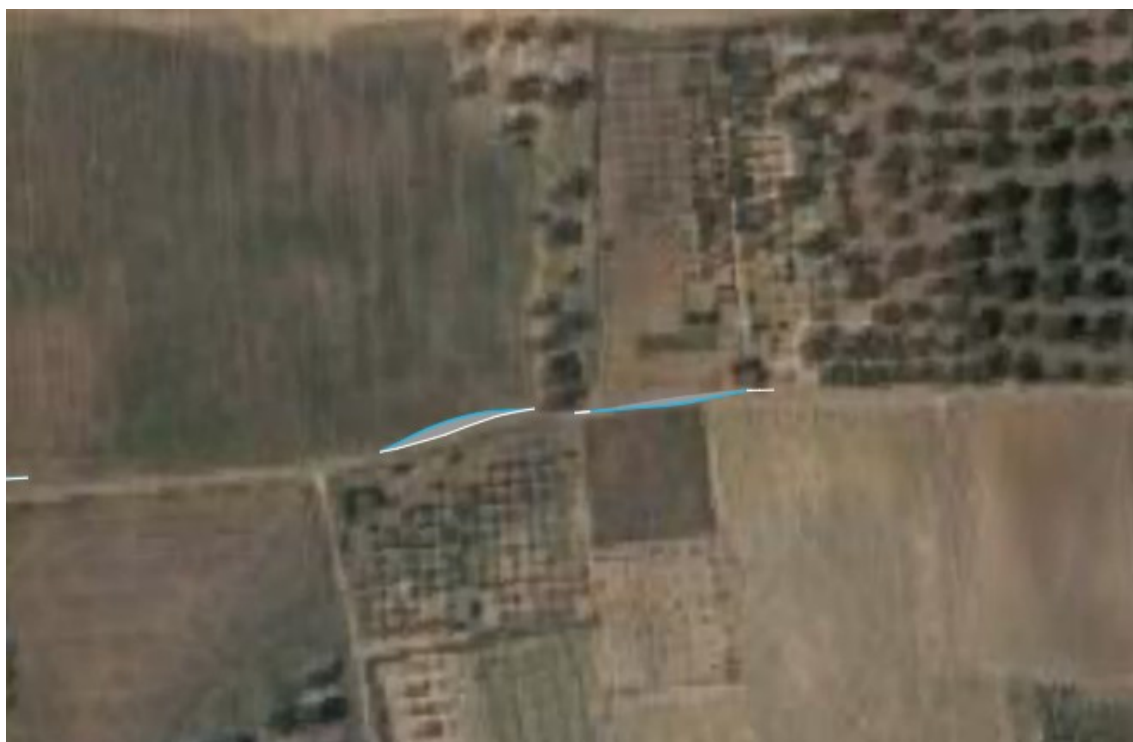
Intervento 7: Si tratta di un allargamento del ciglio di una intersezione onde consentire la svolta a destra per poter arrivare alla torre M07.
