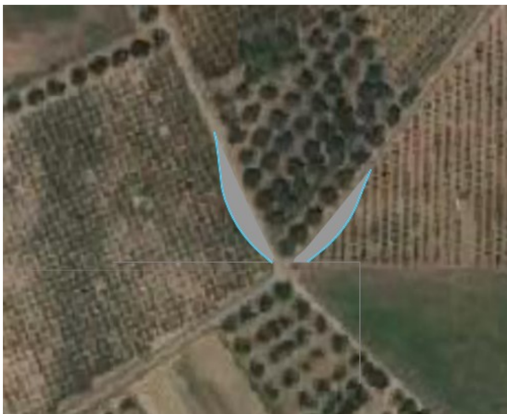
Intervento 4: Consiste in un piccolo allargamento interno di una curva.
