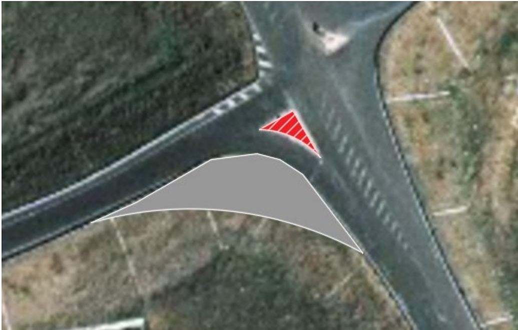
Intervento 2: Allargamento del ciglio destro della intersezione per la manovra a destra da Strada Comunale n. 50 a Strada Comunale n. 16.
