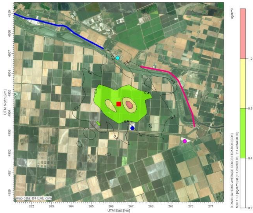
Figura 7.s: Fase 2 – Trava NE-1dir, Mappe di Iso-Concentrazione – Massimi Giornalieri (3° Valore) di SO x (Marzo)
