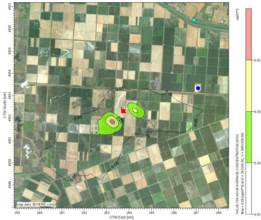
Figura 7.f: Fase 1 - Perforazione Trava-3 dir, Mappe di Iso-Concentrazione – Media Mensile di SOx (Gennaio)
