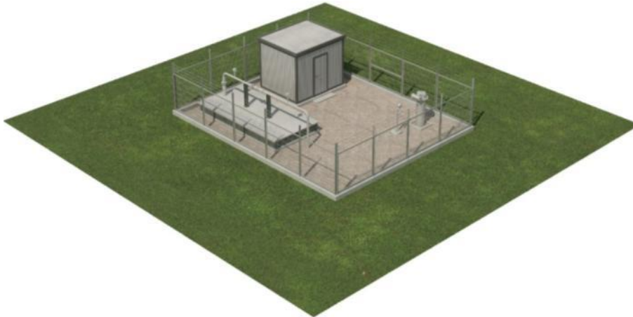
Figura 5.o: Fase 1 - Stazione di Consegna e Misura Fiscale – Modello Esemplificativo in 3D
