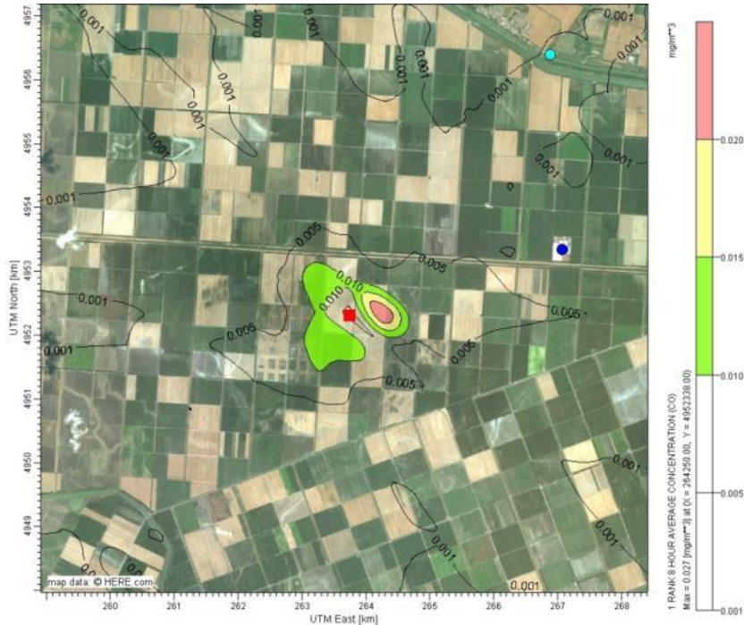
Figura 7.c: Fase 1- Perforazione Trava-3 dir, Mappe di Iso-Concentrazione – Media Giornaliera sulle 8 ore di CO (Gennaio)
