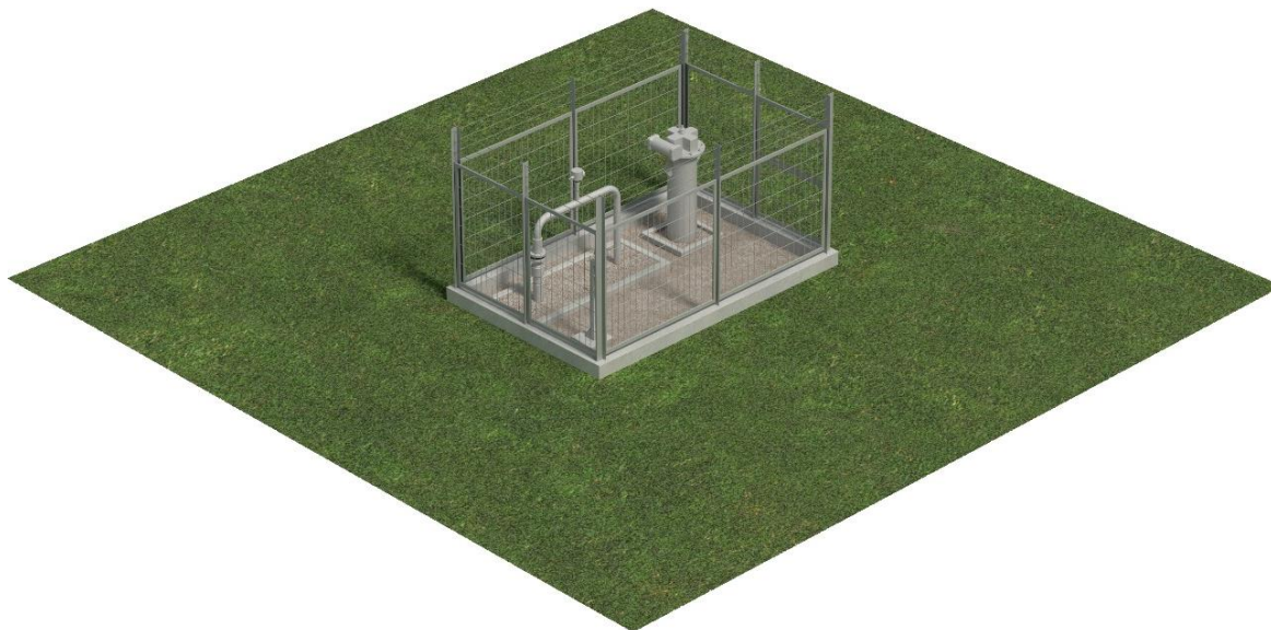
Figura 4.h: Fase 1 – Punto di Intercettazione di Linea PIL – Modello Esemplificativo in 3D
