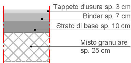
Figura 18 - Particolare della pavimentazione delle strade secondarie
