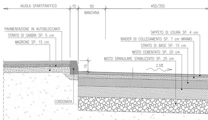
PARTICOLARE PAVIMENTAZIONE STRADALE SCALA 1:20
