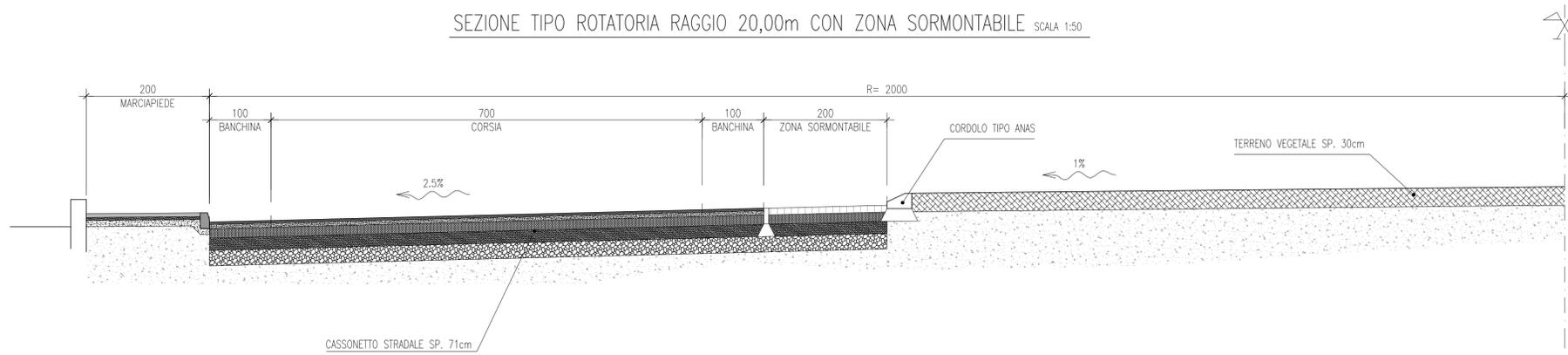
SEZIONE TIPO RAMI DI ACCESSO ROTATORIA SCALA 1:50
