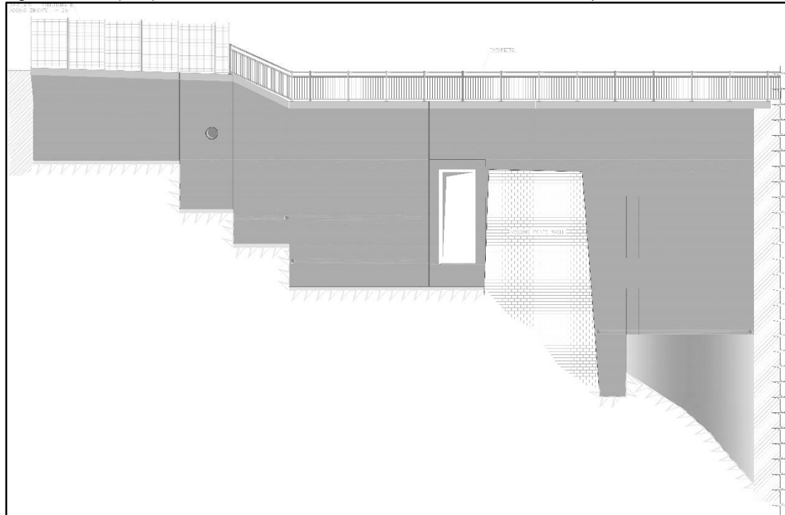
Manufatto di imbocco del nuovo scarico di superficie
