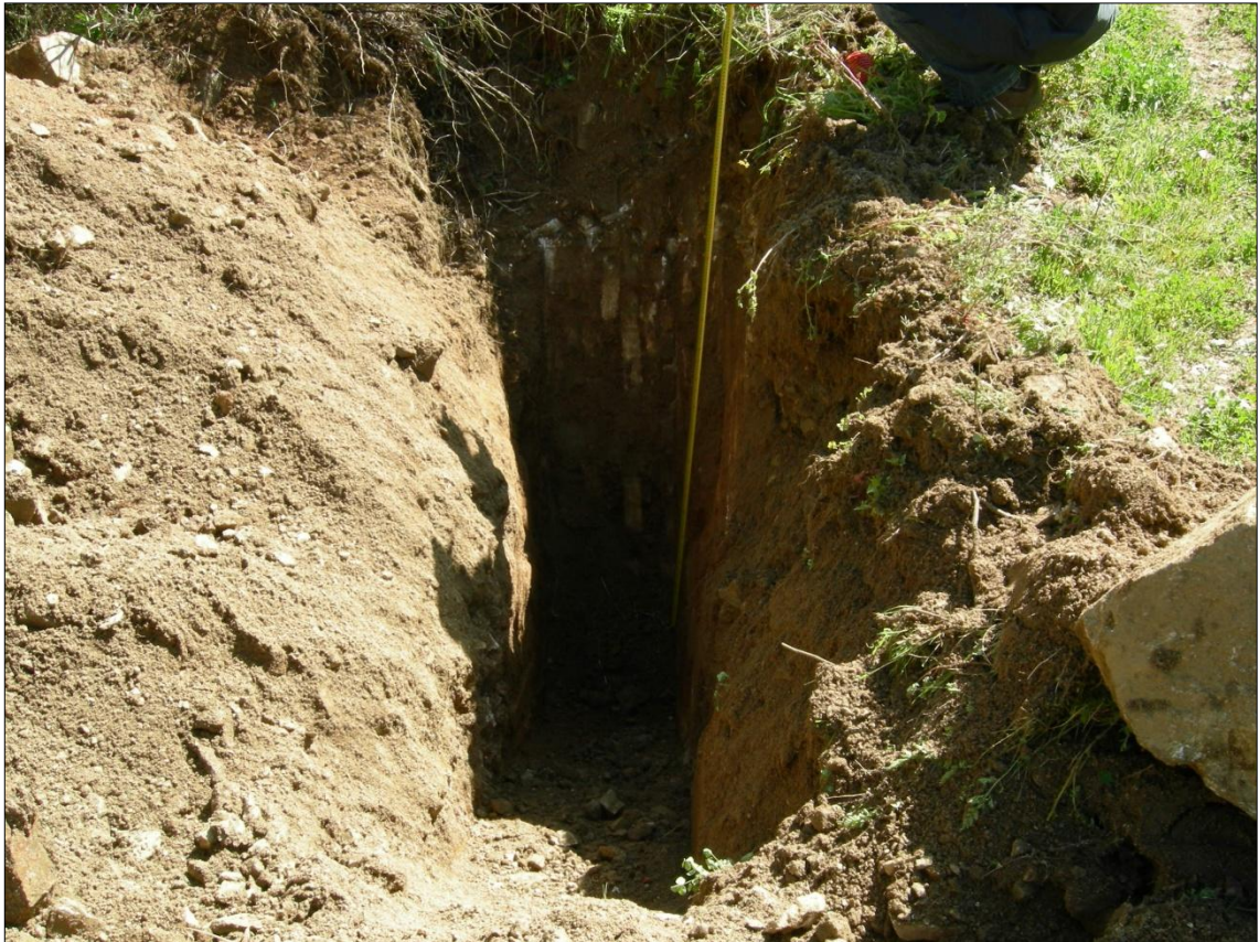
Figura 36 – Foto mostrante il pozzetto stratigrafico P1. Il pozzetto è stato scavato sino ad intercettare il substrato a granodioriti della Facies Porto Rotondo.
