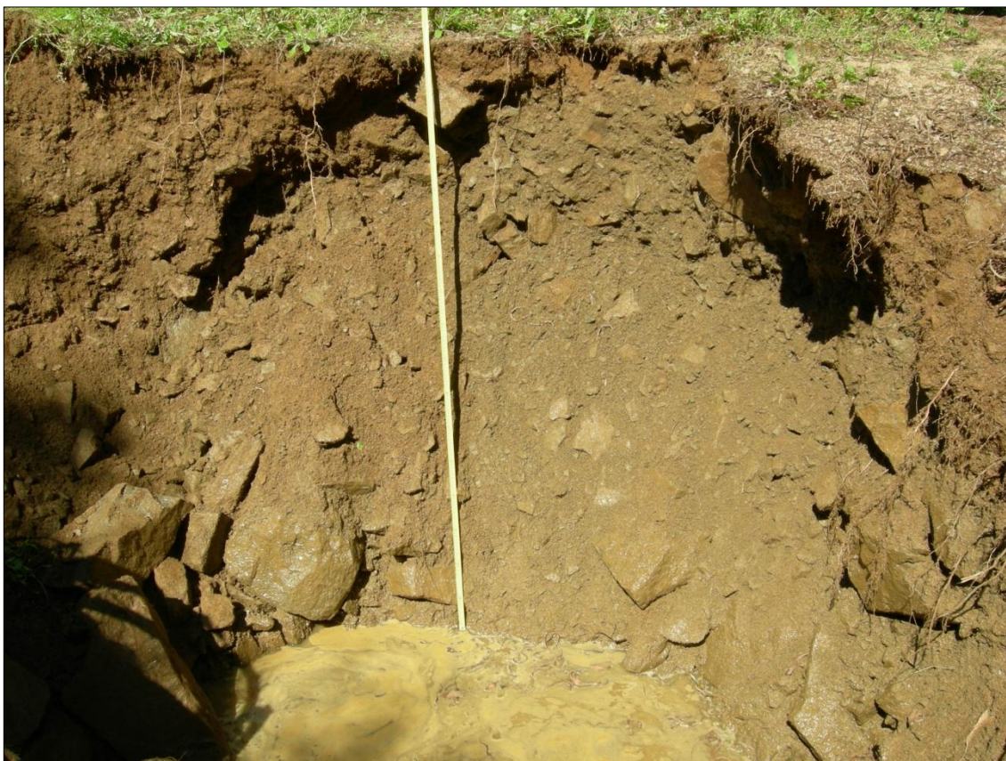
Figura 38 – Foto mostrante il pozzetto stratigrafico P2. Il pozzetto è stato scavato sino ad intercettare il substrato a granodioriti della Facies Porto Rotondo.
