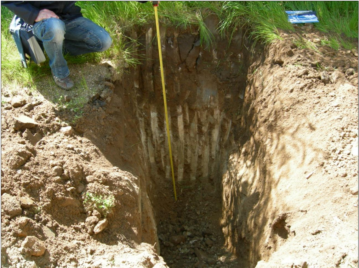
Figura 40 – Foto mostrante il pozzetto stratigrafico P4. Il pozzetto è stato scavato sino ad intercettare il substrato a granodioriti della Facies Porto Rotondo.
