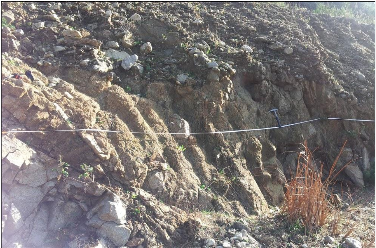
Figura 16 – Stazione di rilevamento geomeccanico dell'ammasso roccioso "St_01". In evidenza la linea di scansione.
