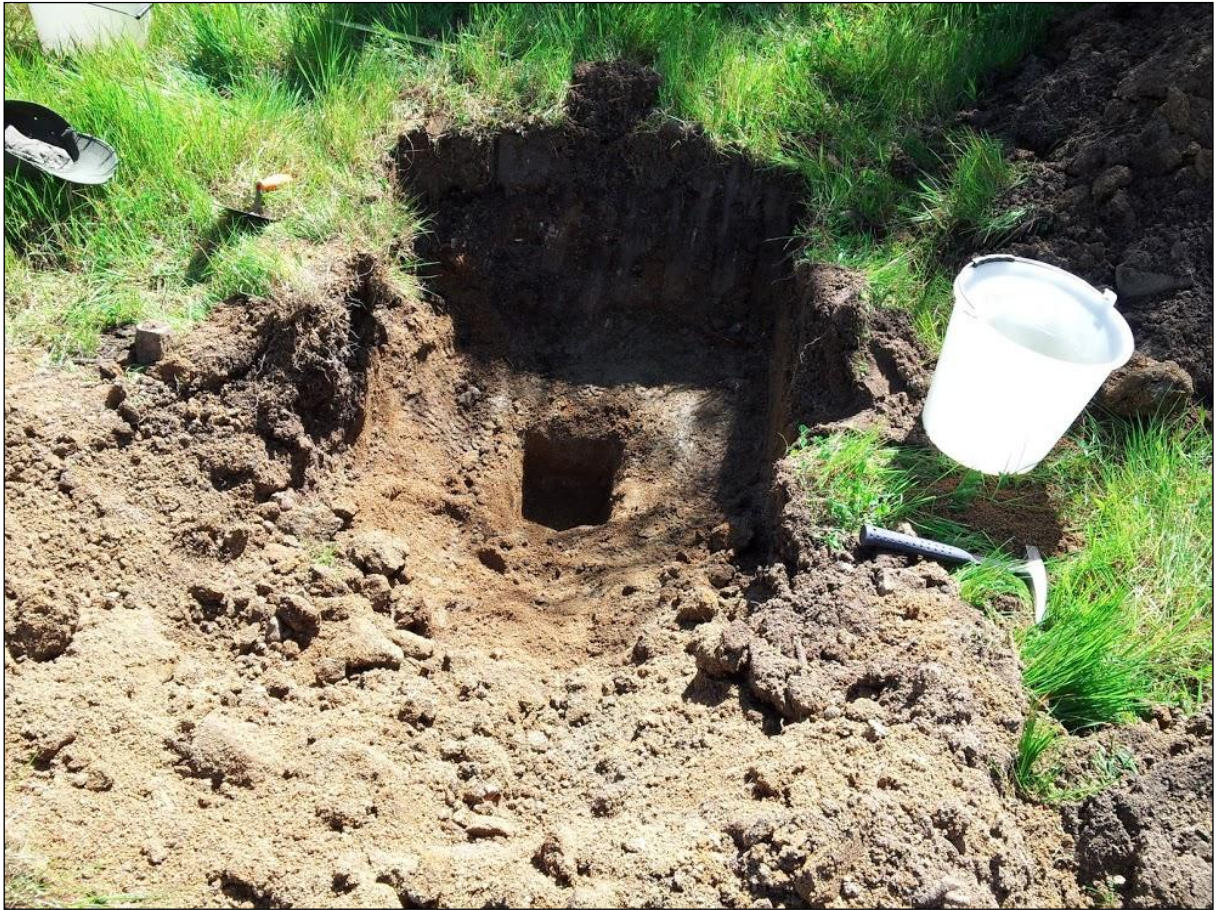
Figura 6 – Foto mostrante il pozzetto utilizzato per effettuare la prova di permeabilità a carico variabile. Il pozzetto di misura è stato scavato all'interno di un pozzo di dimensioni maggiori scavato sino alla quota di -0,50 m rispetto al p.c. per consentire le misurazioni del coefficiente K all'interno del granito arenizzato.
