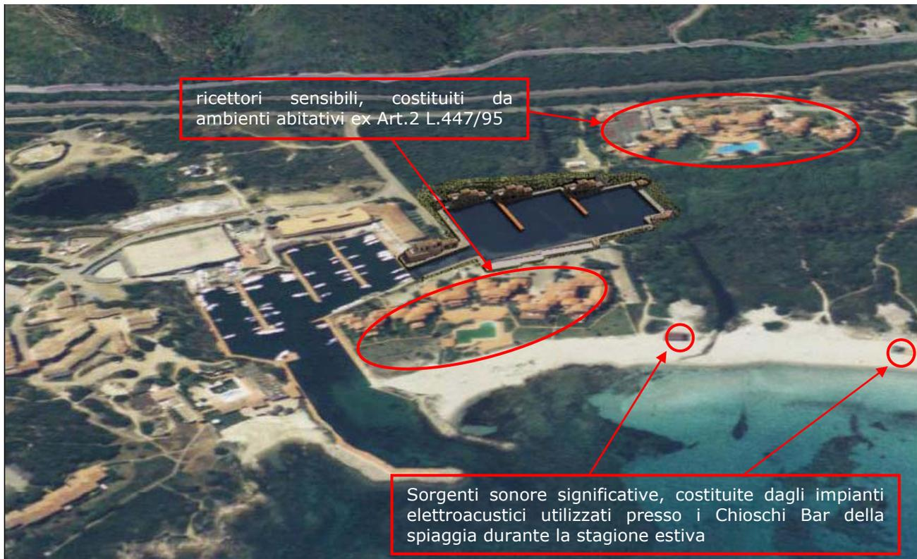
**Figura 8 Simulazione dell'intervento di ampliamento: ubicazione dei ricettori sensibili**
