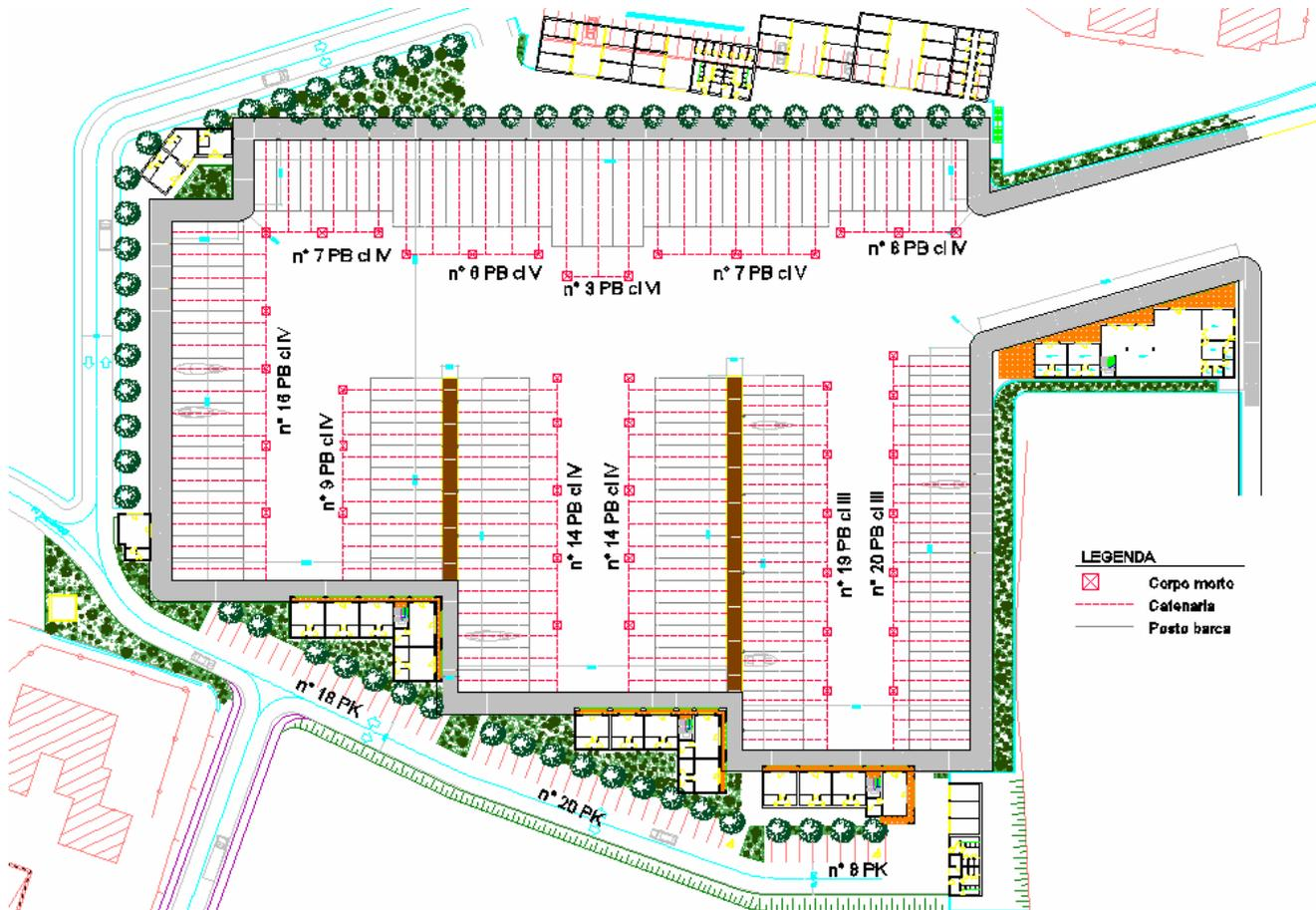
**Figura 1 Progetto ampliamento portuale Porto Marana: schema ormeggi e ancoraggi**
