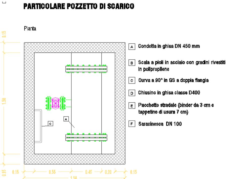
Figura 4.2 – Pozzetti di scarico di linea
