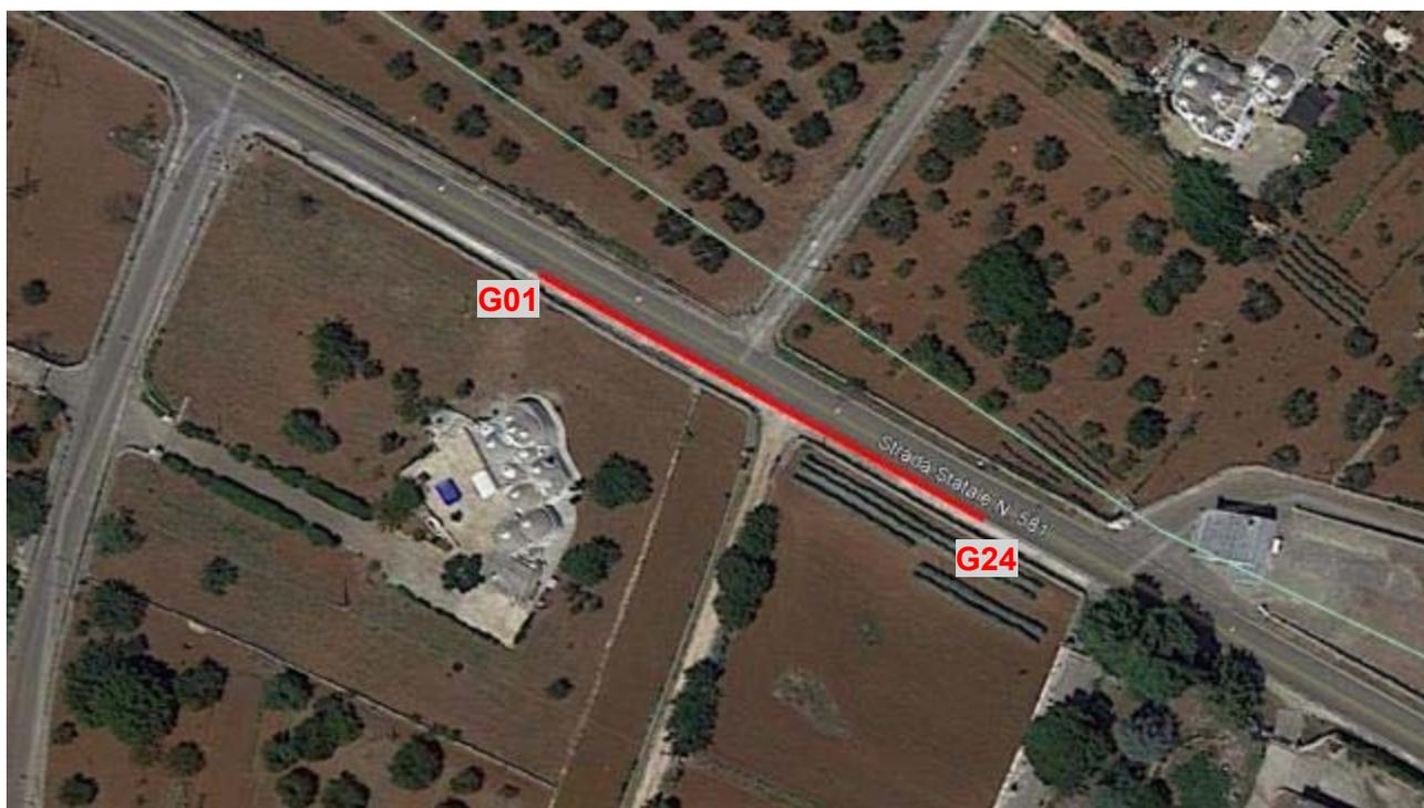
Dettaglio planimetrico del profilo sismico
