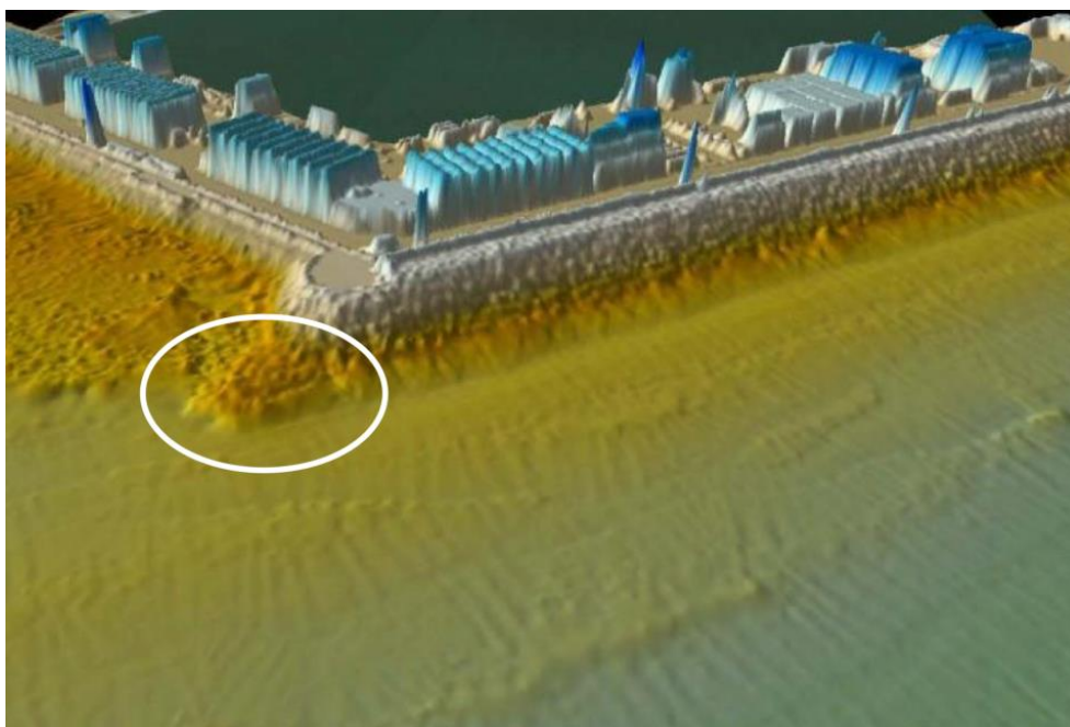
SCOGLIERA SOFFOLTA ESISTENTE IN CORRISPONDENZA DELL'ATTUALE PIAZZALE
