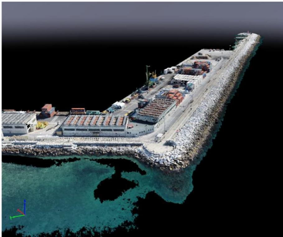
**Figura 20** – Porto di Marina di Carrara (MS): Nuvola di punti ad alta risoluzione del molo di ponente.
