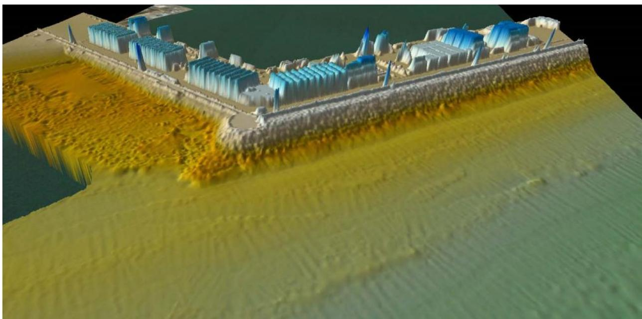
**Figura 24** – Marina di Carrara (MS): Visione 3D del DTM del rilievo topo-batimetrico (SAPR, Mbes, Sbes) eseguito nell'area di indagine. Dettaglio del molo di ponte radice lato mare.
