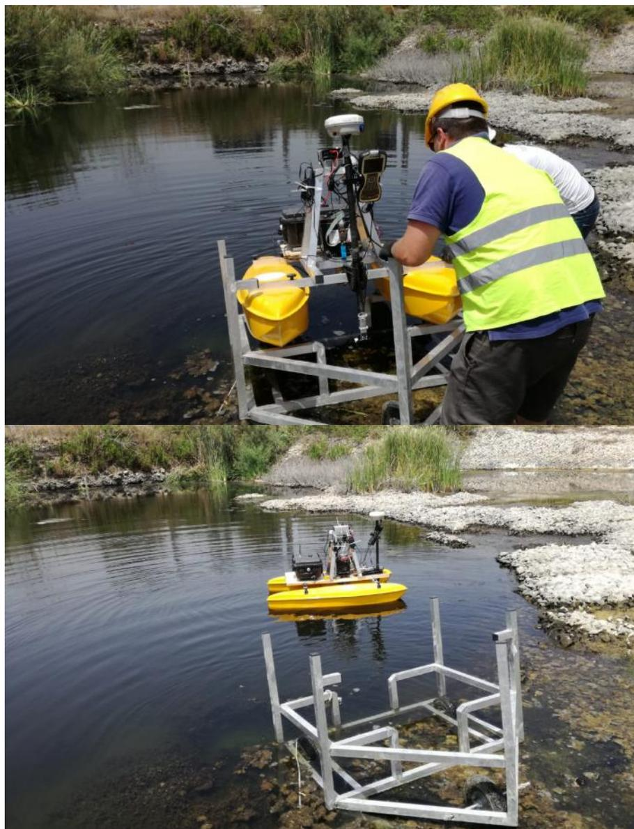
**Figura 6** – Sistema ASV impiegato per l'esecuzione del rilievo batimetrico Sbes: fasi del varo effettuato impiegando l'apposito carrello
