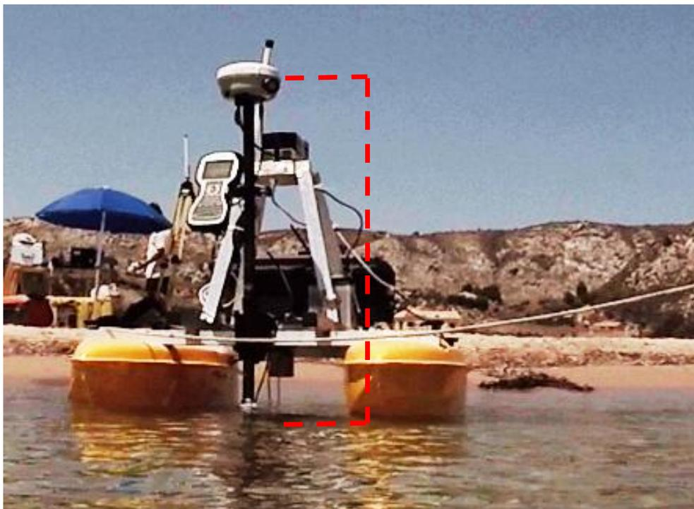
**Figura 8** – Sistema ASV. Dettaglio dell'antenna del ricevitore GPS e del trasduttore SBes montati insieme sulla stessa palina topografica.
