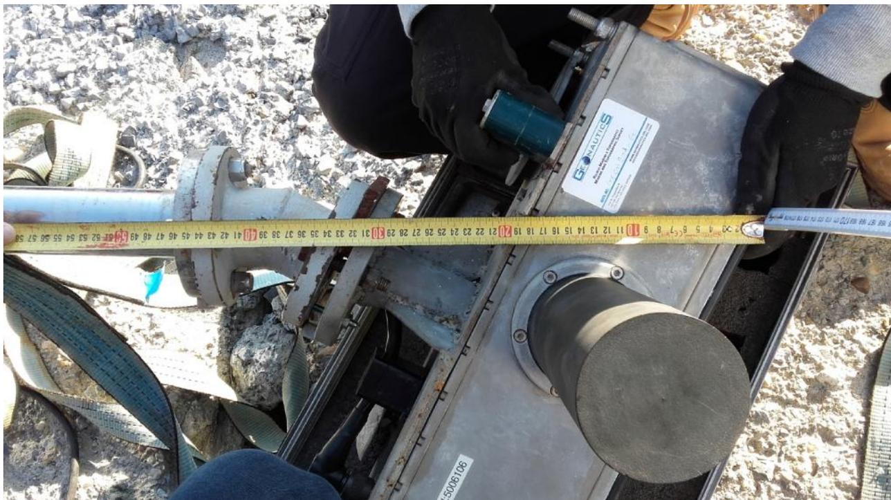
**Figura 14** – Particolare del Trasduttore MBES installato con flangia inclinata al palo in acciaio collegato successivamente alla murata dell'imbarcazione.
