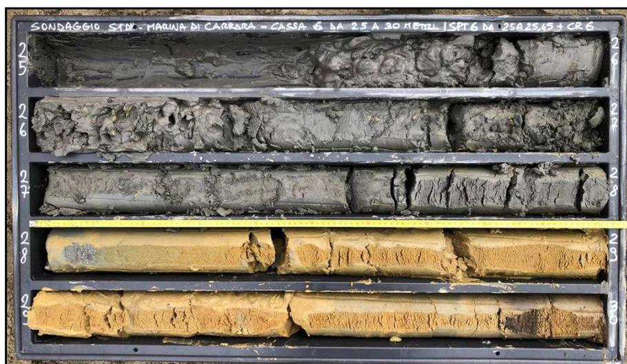
Fig. 7: Sondaggio S1-DH - Cassetta 6 (25 - 30 metri)
