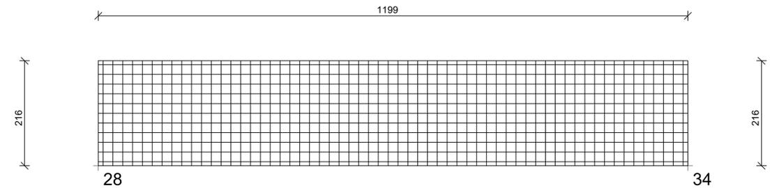
ARMATURA DI BASE SUP.=INF. SETTO 3 QUOTA m.2.60- 4.76
