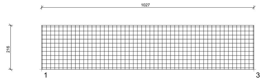
ARMATURA DI BASE SUP.=INF. SETTO 1 QUOTA m.2.60- 4.76
