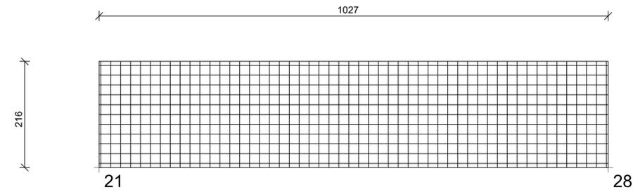
ARMATURA DI BASE SUP.=INF. SETTO 2 QUOTA m.2.60- 4.76
