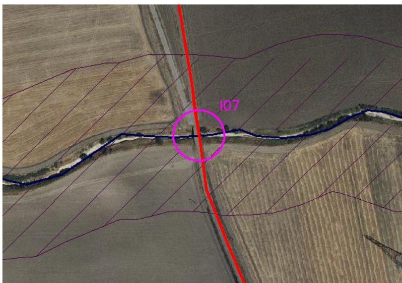
**Figura 19** -individuazione dell'interferenza del reticolo idrografico con il cavidotto MT interno, in rosso il cavidotto interrato in viola il buffer di 75m a delimitare l'alveo in modellamento attivo contermini all'area golenale. L'attraversamento verrà realizzato mediante TOC.
