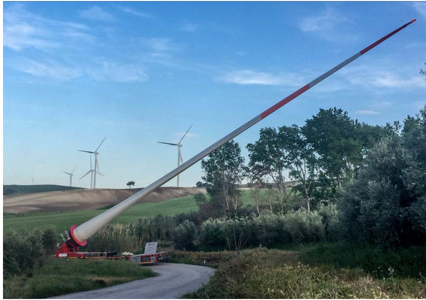
Figura 14: mezzo speciale (bladelifter) impiegato per il transito delle strutture più grandi degli aerogeneratori
