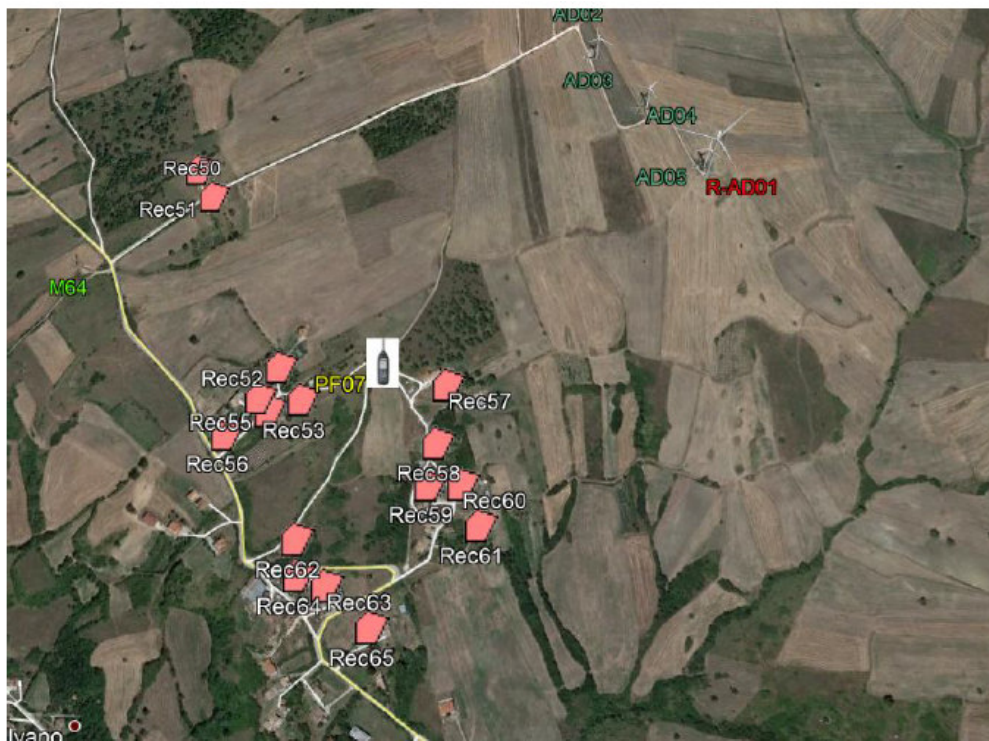
Figura 42: Visione di insieme dei recettori sensibili e dei fabbricati inseriti nel modello di simulazione (poligoni rosa “RecNN”) presenti nell’area Sud Ovest, in agro del Comune di Andretta, con evidenza della postazione fonometrica (PF con simbolo del fonometro)
