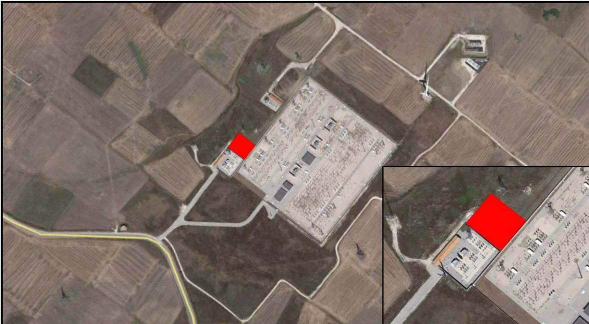
*Figura 81: in rosso l'area occupata dalla SSE di Utenza posta in adiacenza alla SE di Terna.*
