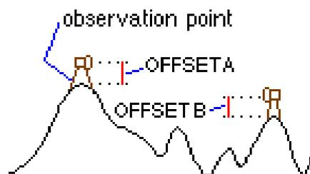
Figura 88: parametri di input per l'analisi di intervisibilità
