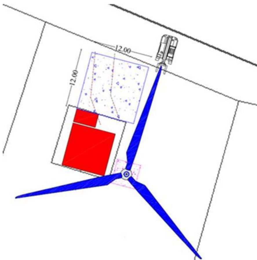
**Figura 3.** Schema tipico piazzola di smontaggio con rotore smontato e appoggiato sulla piazzola 6mx6m: le aree in rosso mostrano la fondazione dell'aerogeneratore (quadrato grande) e la fondazione della cabina (rettangolo piccolo).
