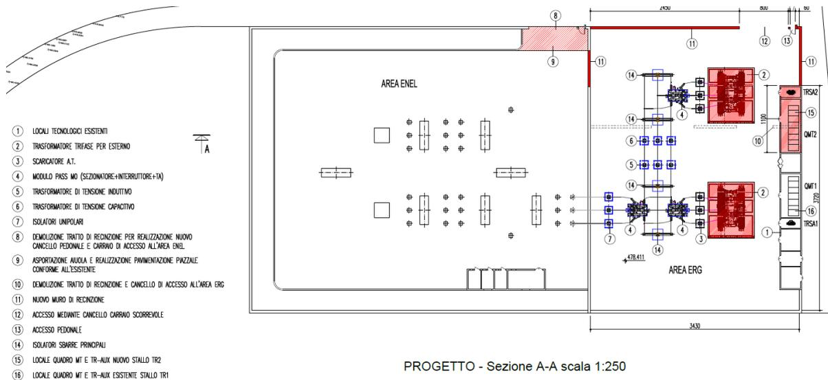
**Figura 2-6 : Planimetria degli interventi di adeguamento della Stazione elettrica**
