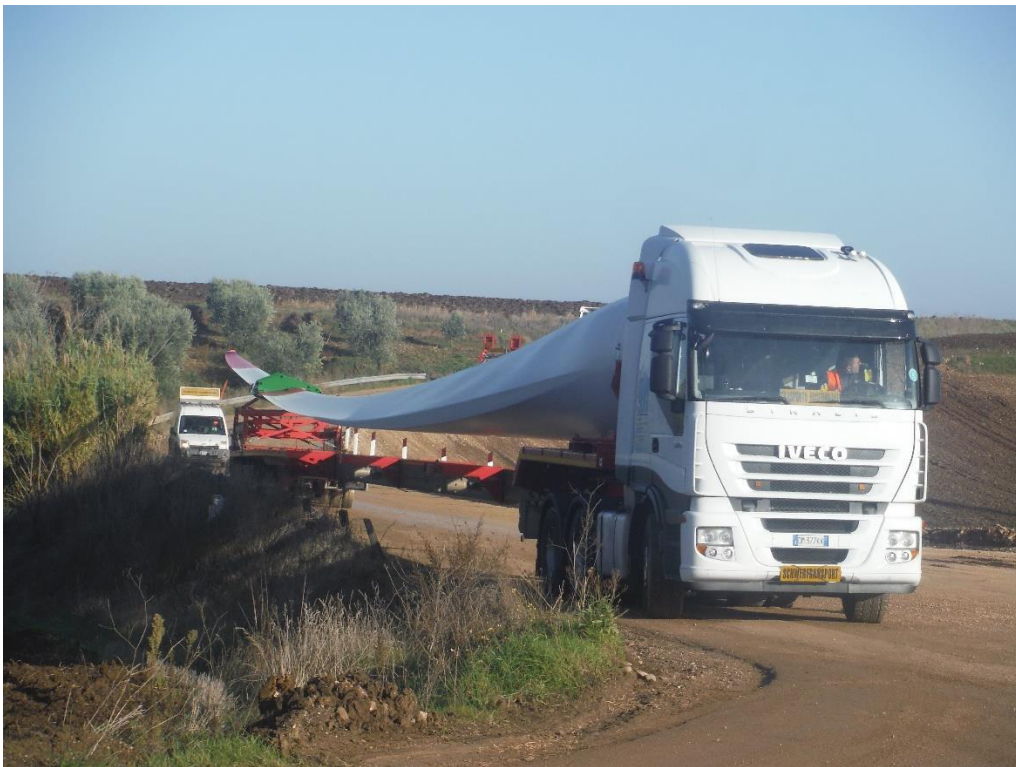
Figura 9_Esempio trasporto pale eoliche - Parco Eolico di Proprietà - Basilicata
