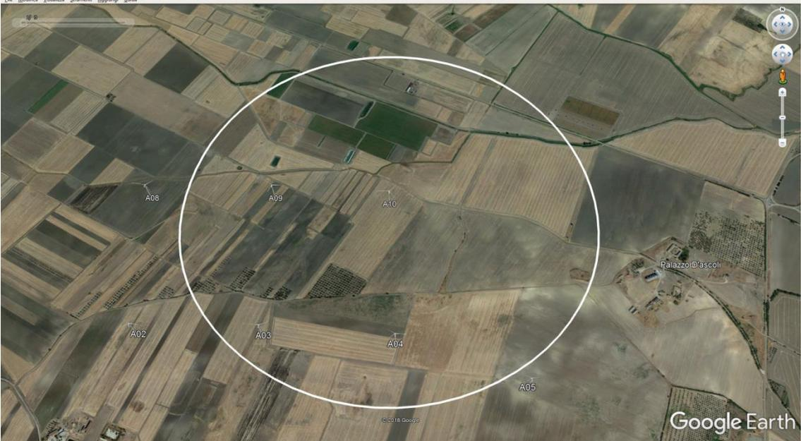
Nel caso in esame, si è valutato l'impatto acustico prodotto dalla pala eolica, tenendo conto anche del contributo di tutte le N macchine già presenti nella zona, a partire dal livello di pressione sonora di ciascuna turbina, rientranti nel raggio di 1000 metri dalla postazione della pala da installare. **Si è proceduto infatti, ad effettuare misurazioni rumore di fondo con lo stato attuale e aerogeneratori esistenti in funzione.**
