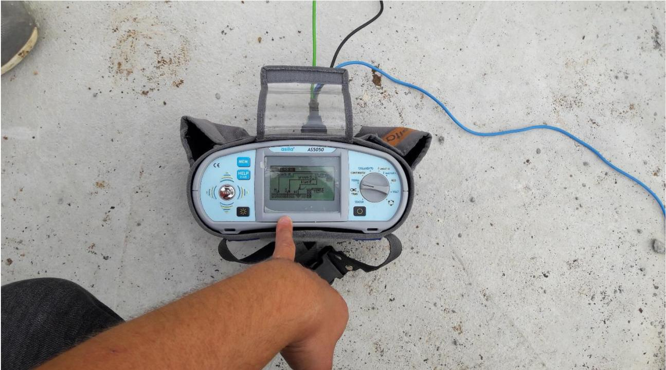
Figura 9\_ Attività di verifica dello stato della rete di terra – Impianto Eolico di Proprietà – Basilicata
