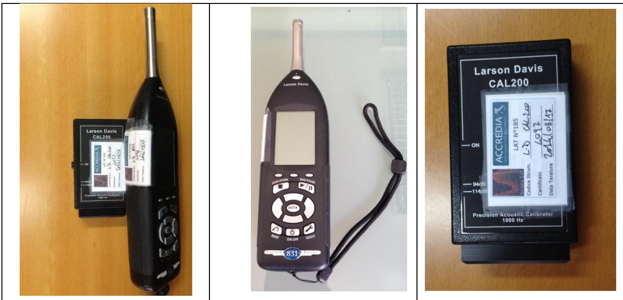
**Figura 18: Strumentazione fonometrica in dotazione**
