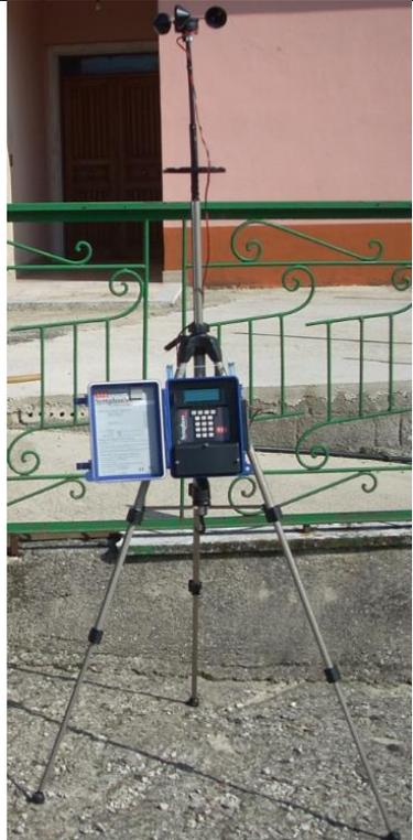
**Figura 19: Stazione meteo portatile utilizzata- l'altezza di misura dei sensori è 1,5 m; Specifiche tecniche dell'NRG #40 Maximum caratteristiche tecniche DATA LOGGER**
