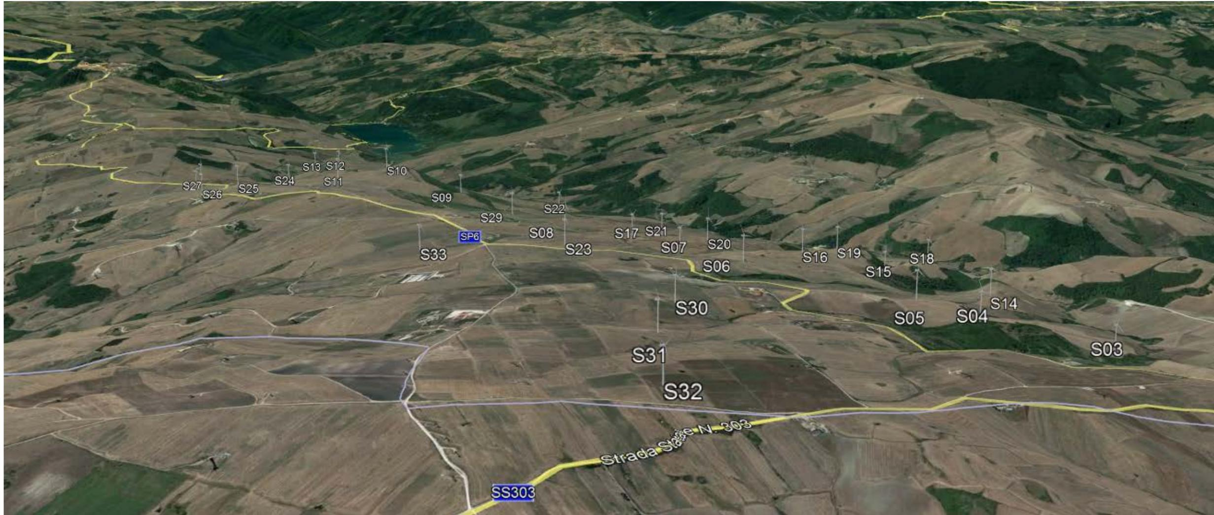
Figura 17: Layout autorizzato a 33 WTG con DD. N.22/2015.
