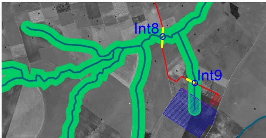
**Figura 15** - Stralcio del Layout di progetto su ortofoto con individuazione delle fasce di rispetto e delle interferenze del reticolo idrografico con le opere in progetto
