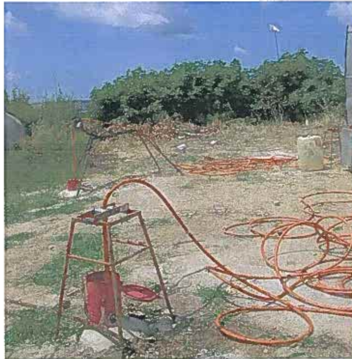
Figura 12: Acquisizione dati cross-hole OTCCH1501-OTCCH2502 onde P (località Cannitello)
