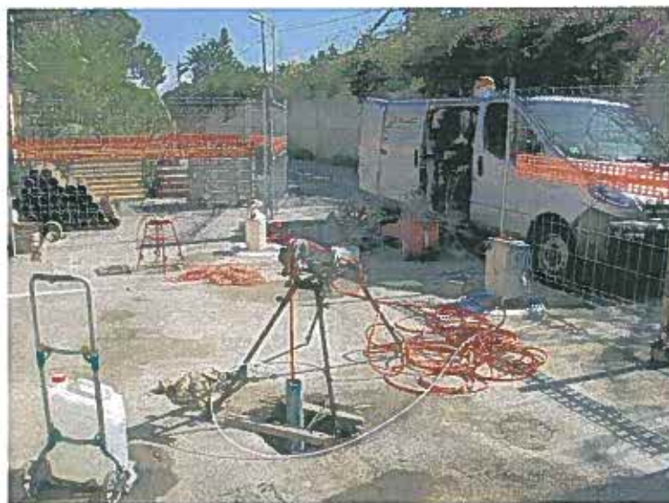
Figura 14: Acquisizione dati cross-hole ASCH1501-ASCH2502 onde S (località Ganzirri)
