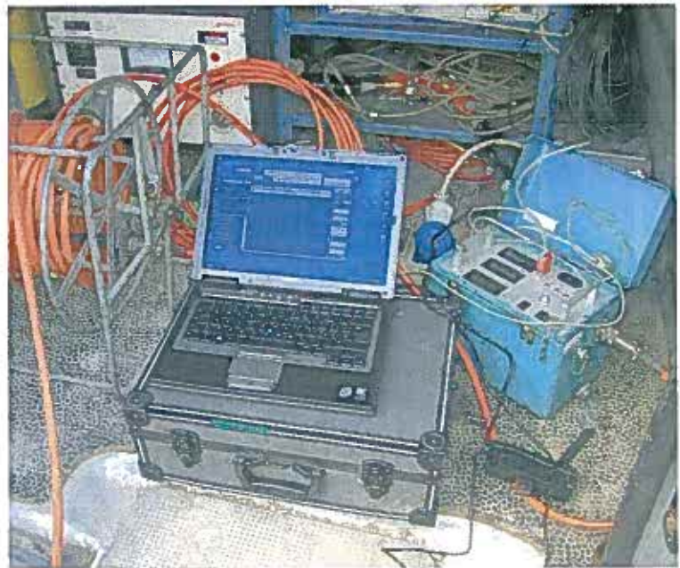
Figura 5: Sistema di acquisizione inclinometriche
