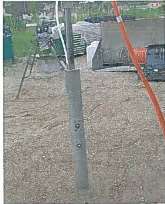
Figura 7: Generatore di onde S "Geos"
