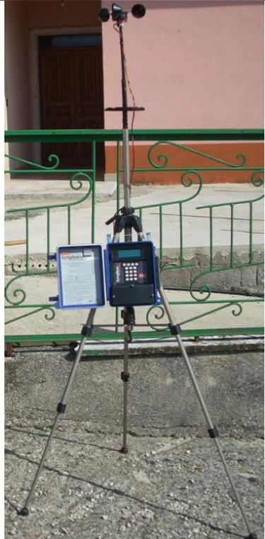
**Figura 14: Stazione meteo portatile utilizzata- l'altezza di misura dei sensori è 1,5 m; Specifiche tecniche dell'NRG #40 Maximum caratteristiche tecniche DATA LOGGER**
