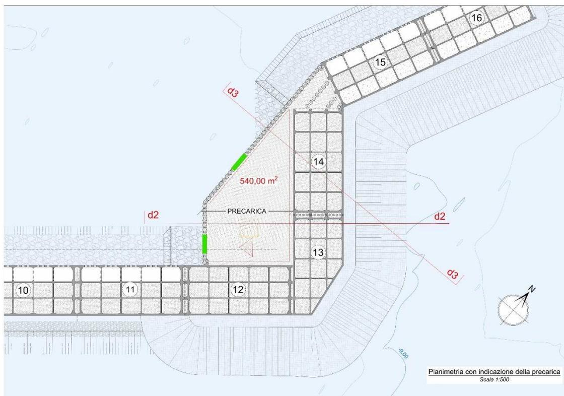
Figura 45 - Planimetria con indicazione delle verticali di Monitoraggio per il Piazzale in testa al Prolungamento del Molo di Sottoflutto
