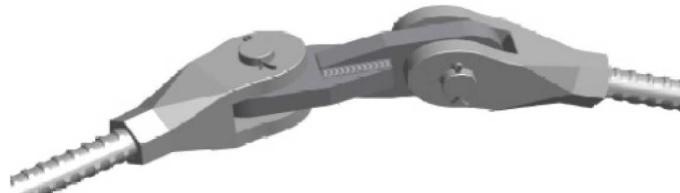
Figura 38 - Particolare di doppia cerniera cilindrica ad assi verticale ed orizzontale
