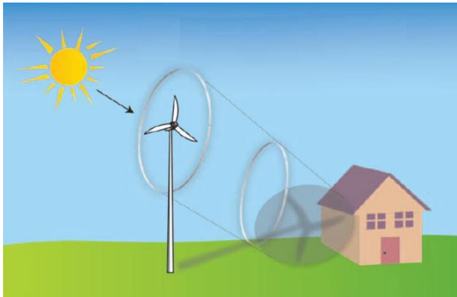
Figura 13: illustrazione del fenomeno di shadow flickering
