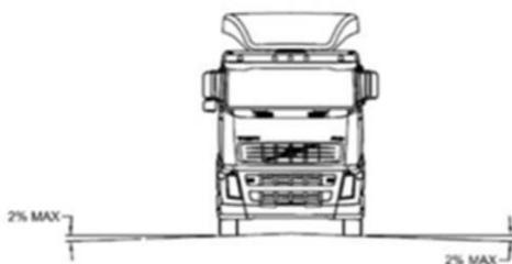
Figura 4: illustrazioni prese dal “*Wind farm Roads Requirements*” della Vestas, relative alla pendenza longitudinale (a) e alla pendenza laterale della carreggiata (b).
