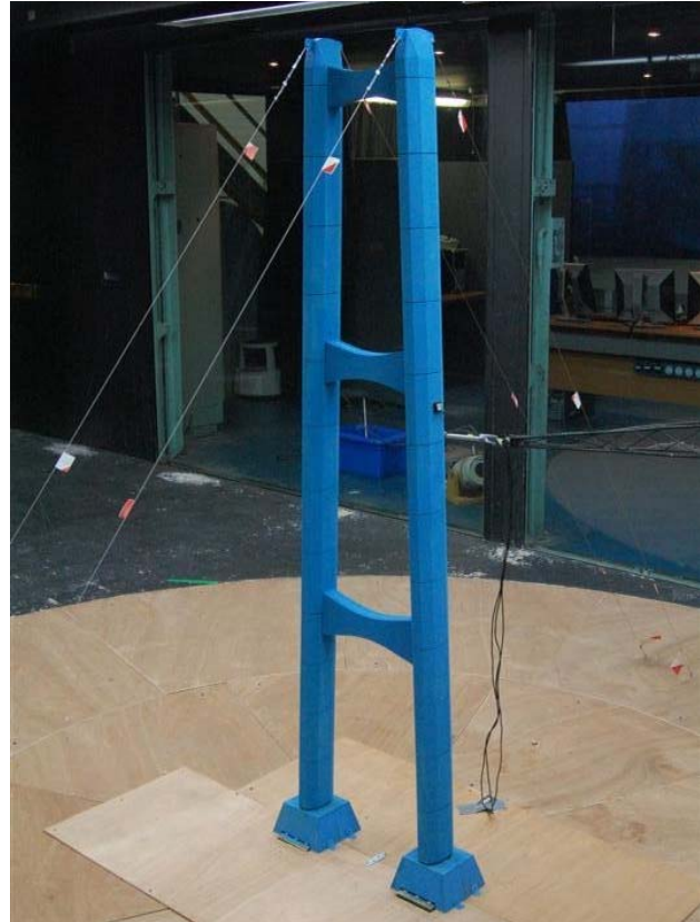
Figura 4 Modello aeroelastico completo prima delle prove BMT. A sinistra, la torre in verticale a destra la torre in service fissata in sommità.
