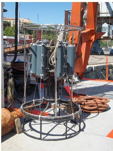
**Fig.2.2 – Bottiglie Niskin per campionamento della colonna d'acqua**
