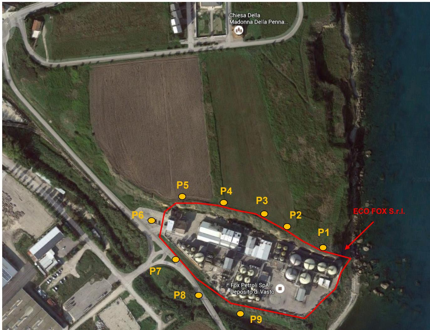
● **Punti di rilievo fonometrico**
